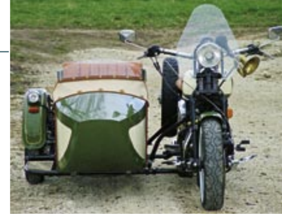
Das Boot hat eine Innenraumbreite von 600 Millimetern. Die Spurbreite ist mit 1290 Millimetern für einen Oldie gerade noch akzeptabel.
