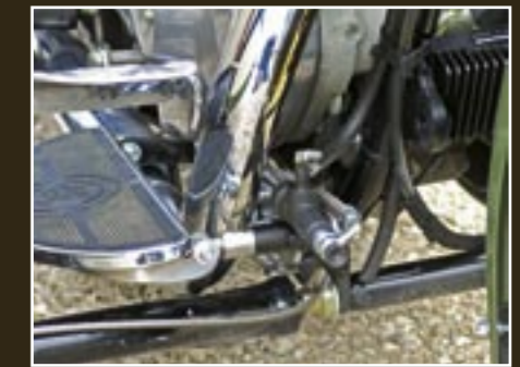
Um den vorderen unteren Anschluß geradlinig zur Maschine führen zu können, musste die Bremsmechanik umgebaut werden. Der neue Bremszylinder hat einen hervorragenden Druckpunkt. Selten sind auch Kugelanschlüsse im Gespannbau geworden. Zwecks einfacherer Demontage im Falle eines Defekts wurden sie hier für die unteren Anschlüsse wieder verwendet.
