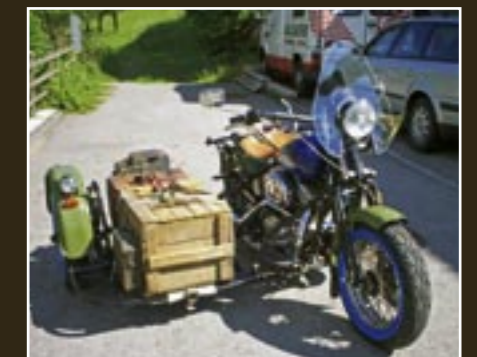
Die Probefahrt kann im August 2006 durchgeführt werden. Die Weißwandreifen sind noch blau, der Tank nicht lackiert, und statt des Blechbootes muss eine Holzkiste als Beiwagengewicht reichen.
