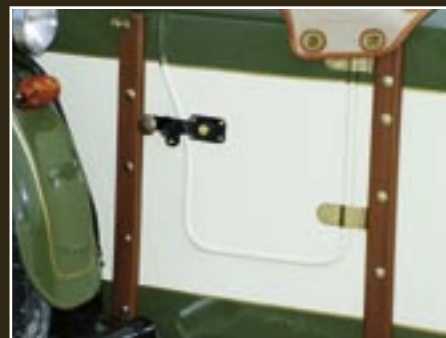
Die Holzleisten stabilisieren mit dem innenliegenden Flacheisenrahmen das Boot. In erster Linie dienen sie aber der Zierde.
